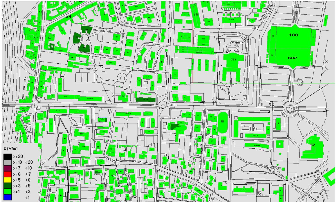
Fig. 13 Impatto Elettromagnetico – zona Viale Italia – Vista dall'alto senza solido
