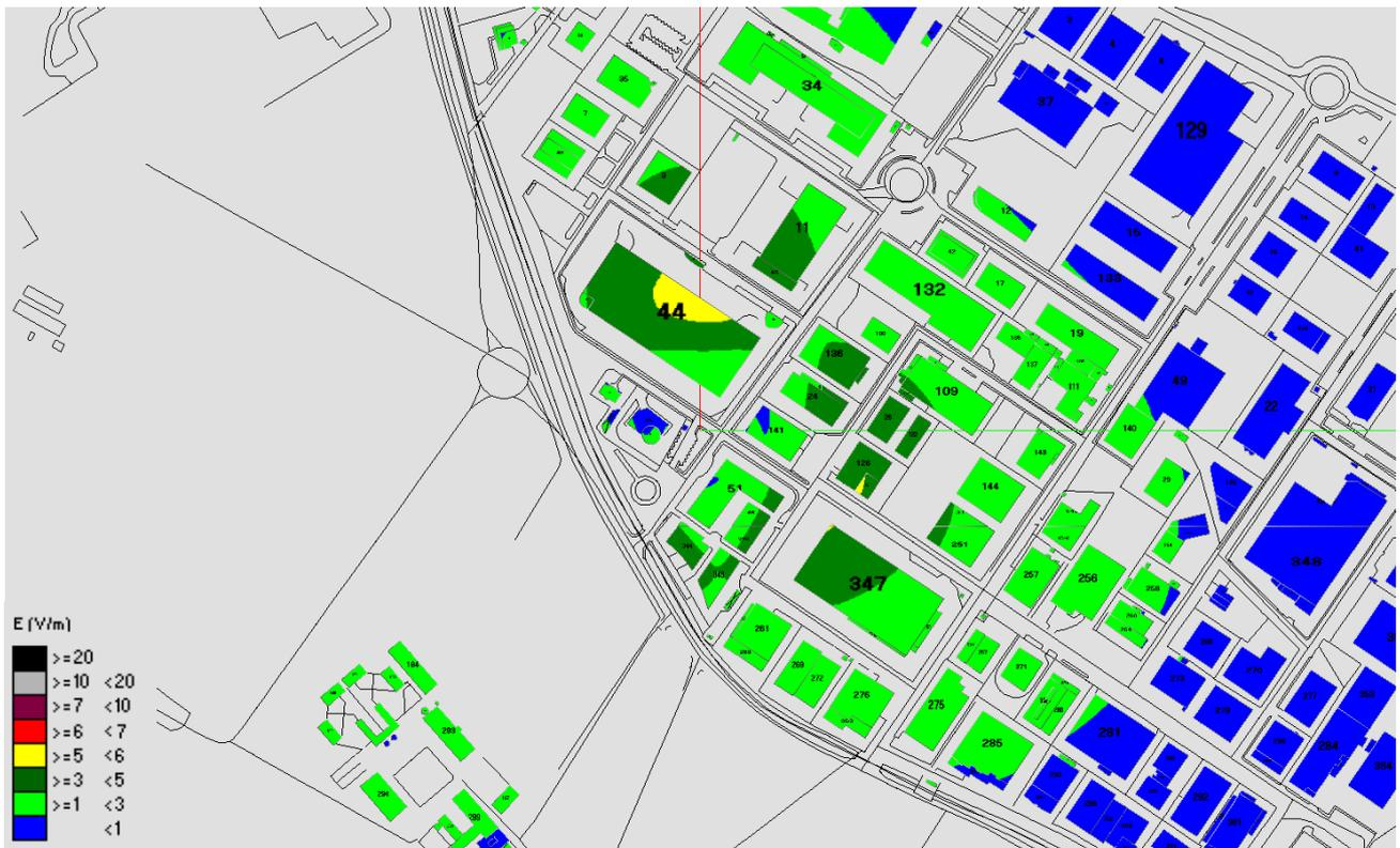
Fig. 33 Impatto Elettromagnetico – zona Zona Industriale Gello – Vista dall'alto senza solido
